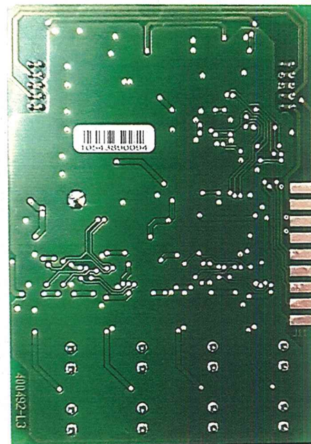
Figura 26. Tarjeta DSB492 vista de soldaduras.
