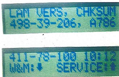
Figura 8. Detalle de la versión del LAM y APPL mostrada en el panel de servicio local del PSS 5000 CPB505-2.
