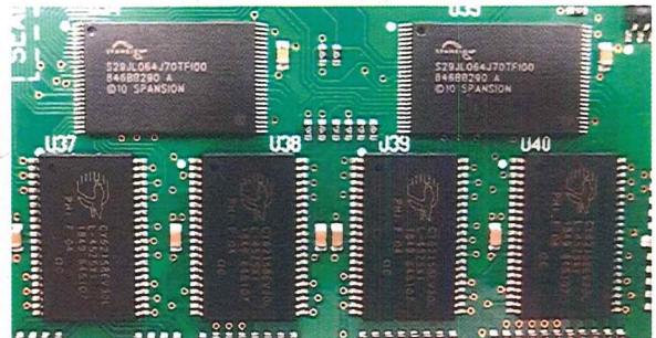
Figura 17. Detalle de las memorias NOR Flash y SRAM del PSS 5000 CPB505-2.
