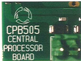
Figura 18. Detalle de la identificación de la tarjeta principal del PSS 5000 CPB505-2.
